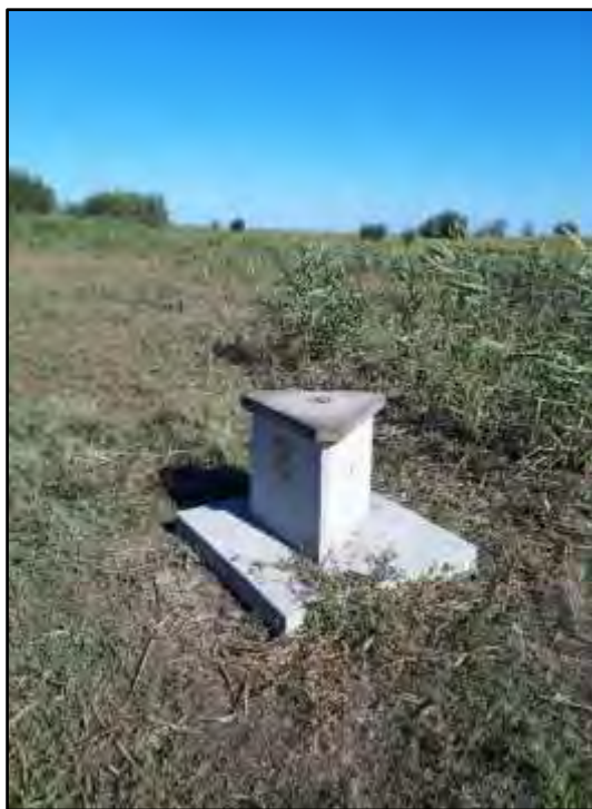
Fig. 3. Bornă geodezică Martor 002-AFDJ, Amonte localitatea Sfântu Gheorghe – km 22.
