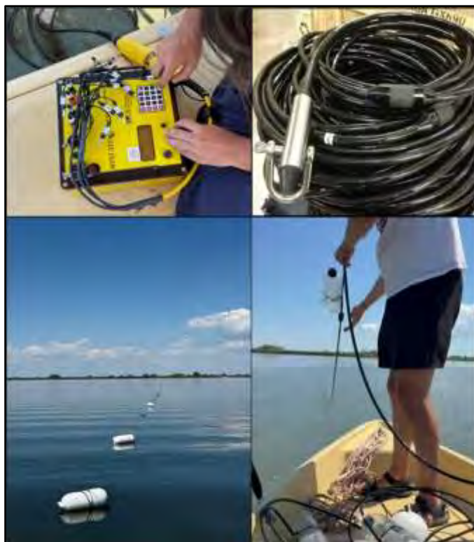
Fig. 1. Sistemul Streamer. Stânga sus – Rezistivimetru. Dreapta Sus – Cablul Streamer echipat cu electrozi. Stânga jos – așezarea cablului în apă, fiind menținut de flotori.
