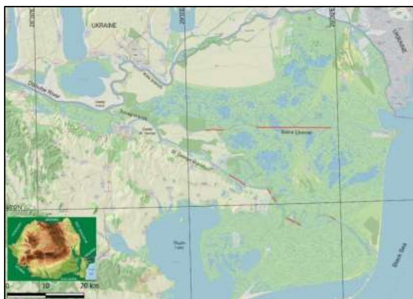
Fig. 2. Harta Deltei Dunării cu cei trei distributari principali (Brațele Chilia, Sulina și Sfântu Gheorghe). Cu roșu sunt marcate canalele artificiale ale meandrelor rectificate pe brațele Sulina și Sfântu Gheorghe.
