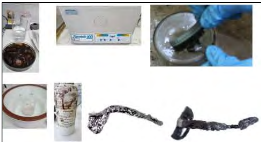
Fig. 3. Restaurarea fibulelor din fier. Îndepărtarea depunerilor, inhibarea și conversia compușilor de coroziune, conservare – în timpul restaurării.
